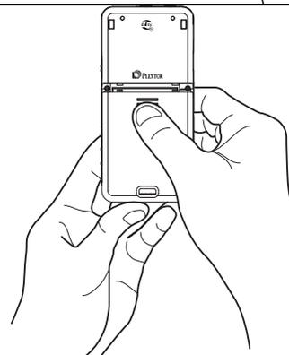
将播放器翻过来，正面朝上。将电源适配器接头插入播放器底部左侧的槽口。
