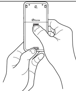
左手持电池，确定电池两处突起位于右侧，另一小块突起位于底部左侧。
