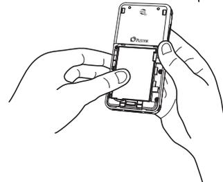
盖上电池盖，置于距合起位置 5mm 处，往上推，直至确定后盖完全合上。
