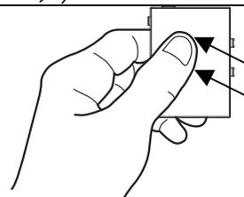
将电池从右侧插入播放器。若从左侧插入，电池会触碰设备，无法插入。
